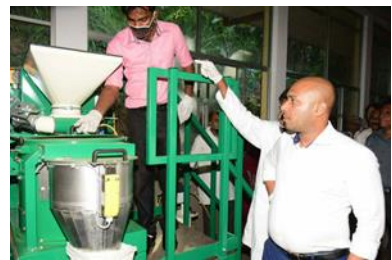
තුනි පටලයකින් ආවරණය කරන ලද කවිපි හා බණ්ඩක්කා ඇට බීජ වලට පටලමය ආවරණය යෙදීමේ යන්ත්‍රය
