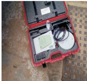
DGPS unit assemblage
