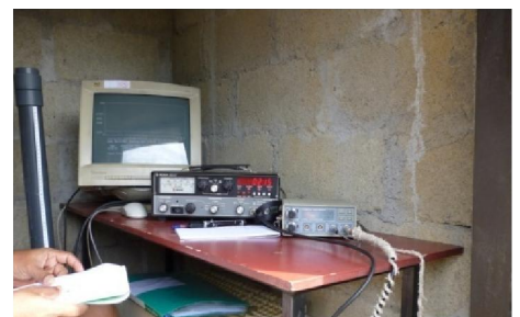
24 වන රූපය: ජල කාන්දු මගෙහි සවිකර තිබූ විකිරණ මාපක වල දත්ත ගබඩා වීමට යොදාගත් උපකරණ පද්ධතිය
