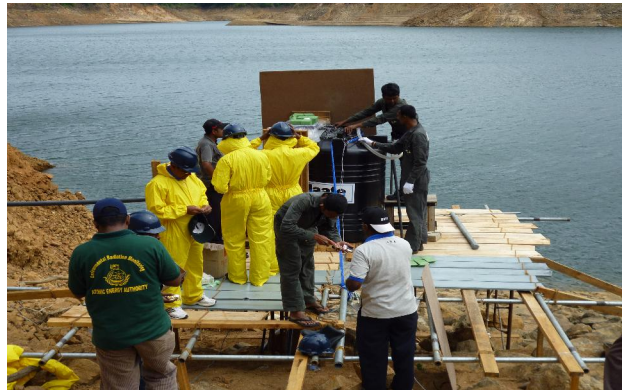
3 වන රූපය: ජල කාන්දුව සිදුවන ස්ථානය සෙවීම සඳහා සමනල වැව ජලාශයට විකිරණශීලී I- 131 මුක්ත කිරීම සඳහා ගොඩනගන ලද ඇටවුම
