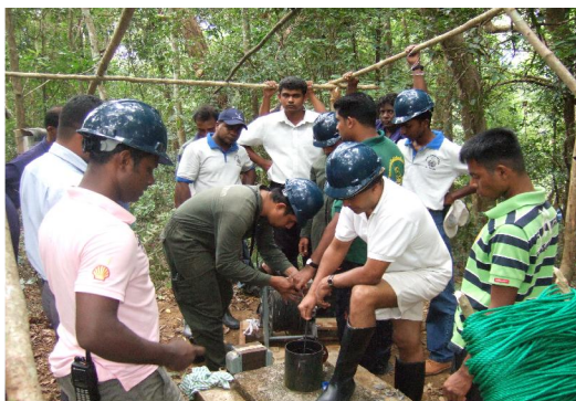
23 වන රූපය: දකුණු ඉවුරේ ඇති භූ ජල නිරීක්ෂණ කුහර වලින් ජල නියැදි ලබා ගැනීම
