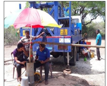
රූපසටහන 13 : ප්‍රජා ජල ව්‍යාපෘතියට අයත් නල ළිඳේ ජල ධාරිතා පරීක්ෂණයක් සිදු කරන ආකාරය
