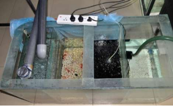
படம் 7 : RAS அமைப்பின் புதிதாக வடிவமைக்கப்பட்ட வடிகட்டி அலகு
