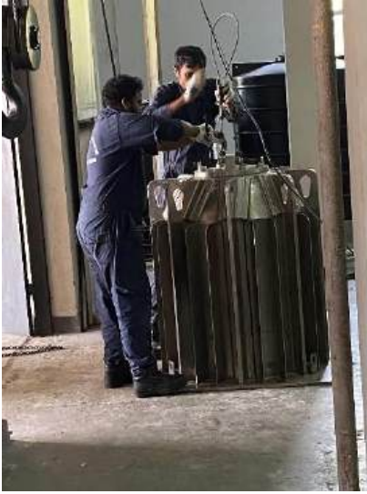
විකිරණ ප්‍රභවය අසුරා ඇති, ඊයම් වලින් නිර්මිත රඳවනය විකිරණ කුටීරයේ ඉහල මාලයට ගෙන එම
