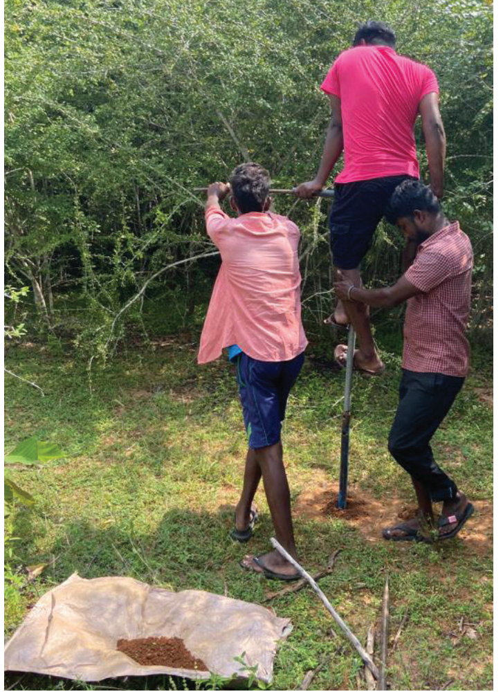
படம் 3: புவி-இரசாயன வரைபடமாக்கல் நடவடிக்கைக்காக திருகு மண் அகழ்வி முறை மூலம் மண் மாதிரி எடுத்தல்
