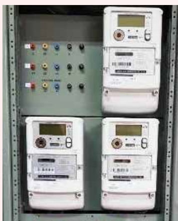
වෝල්ටීයතා අවහරිතාවීම් හා අවම කිරීමේ ක්‍රම සොයා ගැනීමට නිර්මාණය නැවත කලාස්ථ කිරීමේ අපවර්තකය වෙනුවෙන් කරන ලද බෙදාහැරීම් රේඛාවේ ඉදිරි පැනල ආකෘතිය
