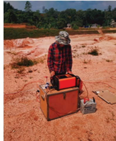
රූපය 40: මධ්‍යම අධිවේගී මාර්ගය ආශ්‍රිතව ද්විමාන ප්‍රතිරෝධකතා සමීක්ෂණ (2D resistivity surveys) සිදු කිරීම
