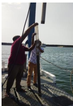
රූපය 10: මුහුදු පතුල බනිජ විභවයන් සඳහා Vibro-corer භාවිතා කිරීම (වම) විශ්ලේෂණය සිදු කරන ප්‍රදේශය (දකුණ)
