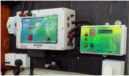
නැනෝ විෂන් අනුරාධපුර (පුද්ගලික) සමාගම සඳහා 20J විදුලි අලි වැට සඳහා භාවිත කෙරෙන එනර්ජයිසර් යන්ත්‍රයක්
