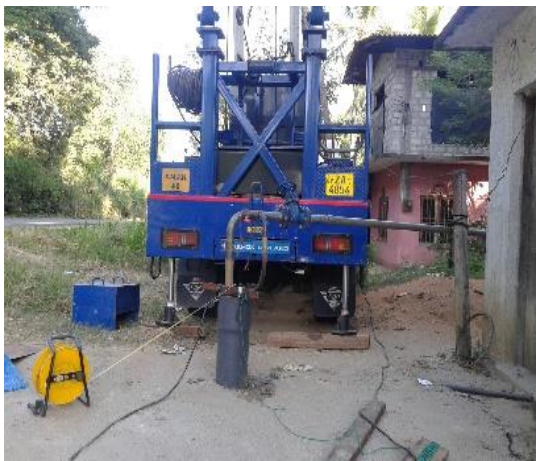
රූප සටහන් 9 සහ 10 : මොණරාගල ප්‍රදේශයේ ඉදිකරන ලද නල ලීඳක ජල ධාරිතා පරීක්ෂණ සිදු කිරීම
