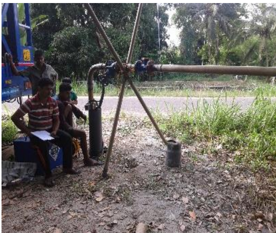
රූප සටහන් 9 සහ 10 : මොණරාගල ප්‍රදේශයේ ඉදිකරන ලද නල ලීඳක ජල ධාරිතා පරීක්ෂණ සිදු කිරීම
